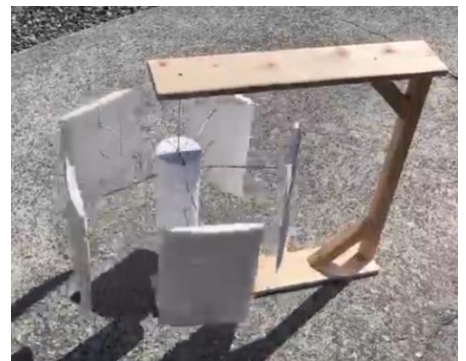
垂直揚力型風車 (飛行機の原理で回転！)
